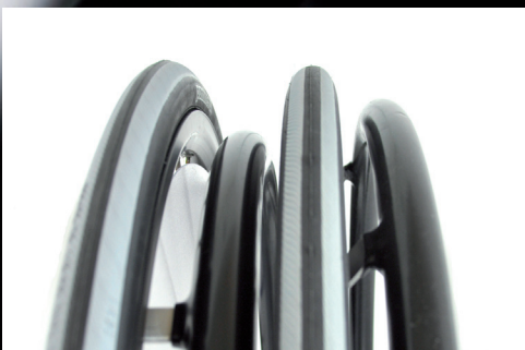
SKILLNAD I DIAMETER PÅ DE GAMLA DRIVRINGARNA JÄMFÖRT MED DE NYA TILL HÖGER. 530 MOT 560 MM
