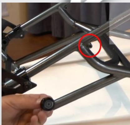
2) Börja med det främre fästet, som ska monteras i det främre gängade hålet i ramen på höger sida..
