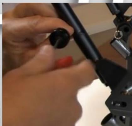
4) Fortsätt montera det bakre fästet i det gängade hålet i ryggestativet på höger sida. Drag åt med insexnyckel 3 mm.
