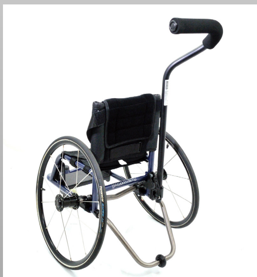
Fig. 8 Justera körbågen till önskad höjd och lås fast den genom att trycka ned spaken. Om spaken spänner för löst eller för hårt kan man justera förspänningen genom att vrida på spaken medurs för att öka förspänning och moturs för att minska den.
