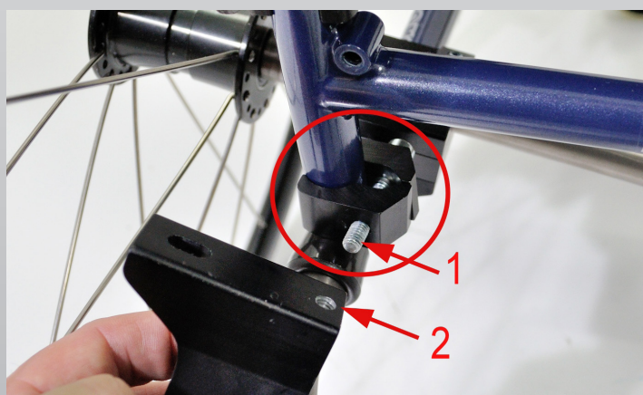
Fig. 3 Placera fästet, vänster (del 4, 5 och 6 i fig 1) runt ramröret som bilden visar. Håll fast delarna med handen och skruva fast skruven 1 in i fästet 2 med fingrarna tills fästet sitter kvar på röret.
