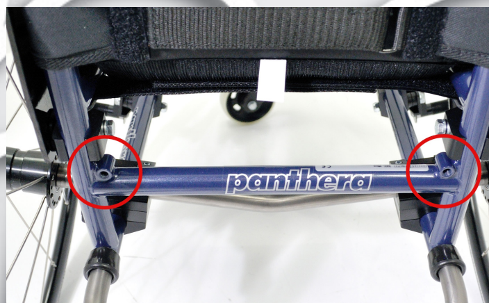
Fig. 2 Baktill på chassit finns två gängade fästen fastlödda. De används till att fästa körbågen i, en för vänster resp. höger sida.
