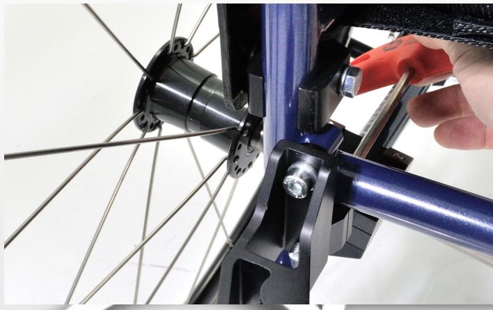
Fig. 5 Drag åt den främre skruven som håller fästet runt ramröret med insexnyckel 5 mm
