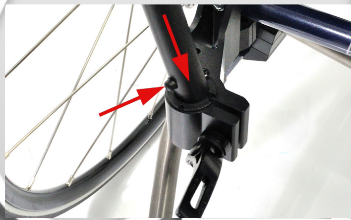
Fig. 7 Placera körbågen i fästet och tryck in låssprinten för att kunna få ner det genom hylsan.
