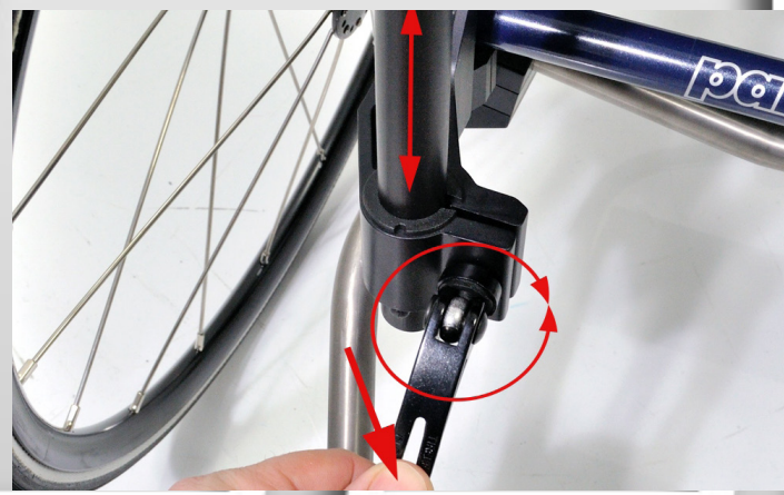
Fig. 8 Justera körbågen till önskad höjd och lås fast den genom att trycka ned spaken. Om spaken spänner för löst eller för hårt kan man justera förspänningen genom att vrida på spaken medurs för att öka förspänning och moturs för att minska den.
