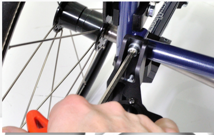
Fig. 6 Drag åt den bakre skruven som håller fästet fast i det gängade hålet i ramen med insexnyckel 5 mm.
