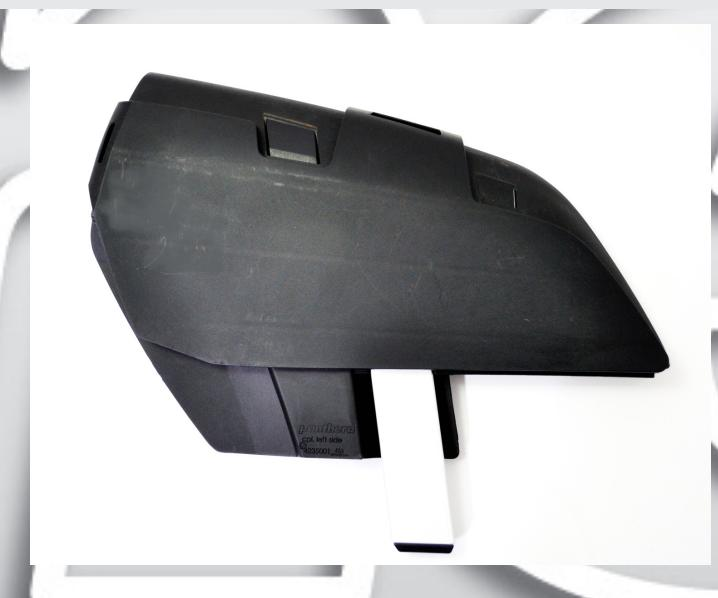
**2)** För upp adaptern längs profilen, tills den ligger över sidoskyddet. Pressa på övre och bakkanten av adaptern tills den snäpper fast över kanterna på sidoskyddet.
